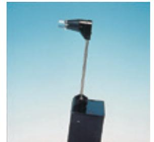
トノセーフは、ゴールドマンアプラネーショントノメータおよびパーキンス氏手持眼圧計に取付けて使用する、滅菌済のメジャリングプリズムです。プリズムはホルダー部分と分離して個々にパッキングされており、使用毎に新しいプリズムをホルダーに取付けて使用することにより、被検者間の相互感染の心配をなくしました。
